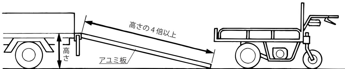
2. アユミ板のフックは、荷台に段差のないように、また、ずれないように確実に掛けてください。
