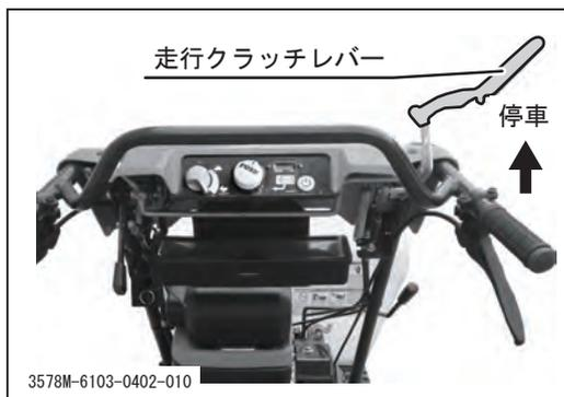
2. 走行クラッチレバーを[停車]にし、車両を停止させます。
