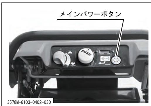
5. メインパワーボタンを押します。パワーが[ON]になると警告音が鳴り、車体のメインパワーランプとバッテリーパックの充電レベルインジケータが点灯します。
