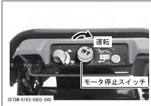
6. モータ停止スイッチを下に押したまま右に回し、[運転]にします。
