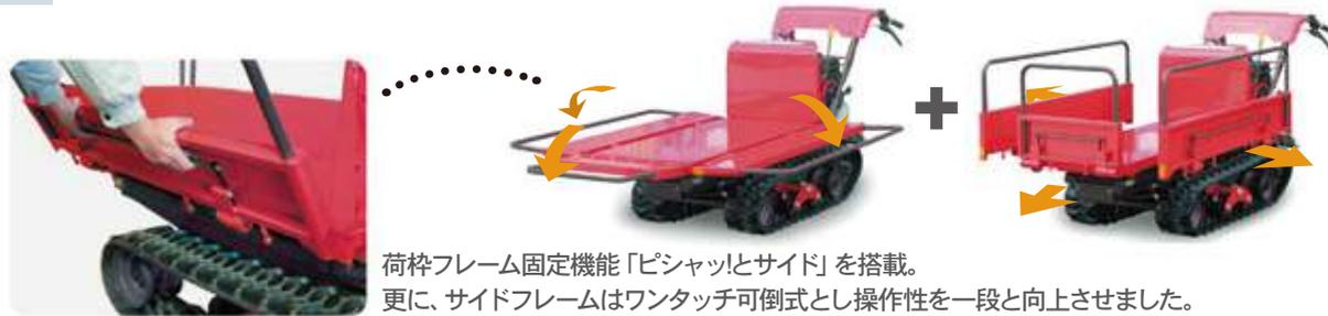
荷枠フレーム固定機能「ピシャッとサイド」を搭載。更に、サイドフレームはワンタッチ可倒式とし操作性を一段と向上させました。
