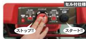
ボタンを押すだけでエンジンを簡単に始動・停止できます。また、クラッチ入ではエンジンが始動しないので安心です。
