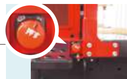
緊急停止スイッチ 後進時に万が一 挟まれそうになった場合 スイッチひと押しで エンジンを停止させます。
