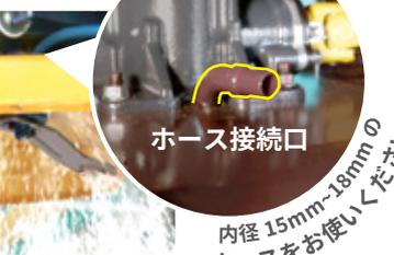
刈高さを 50mm に設定。ホースを接続して刈刃を回して洗浄。
