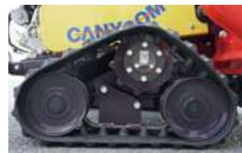
**追従機構** 追従式フレックス機構で、草刈後が凹凸の少ない仕上がりに。
