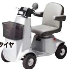
機械寸法 長1110 幅635 高1035mm
