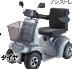
機械寸法 長1190 幅670 高1120mm
