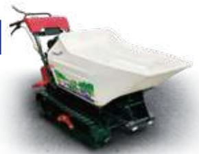
機械寸法 長2045~2140 幅740 高1055~1150mm
