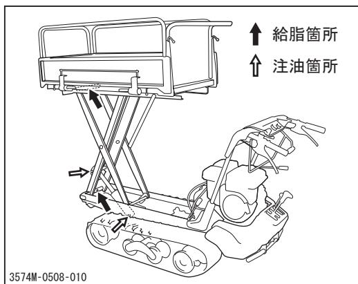
1. 荷台を上昇させ、荷台落下防止板で確実に固定します。
