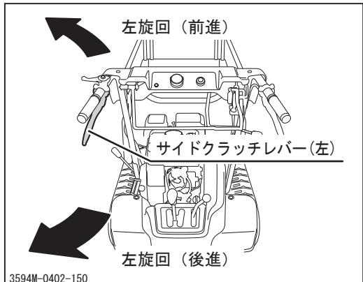
6. 左旋回したい場合は左側のサイドクラッチレバーを握り、旋回します。
