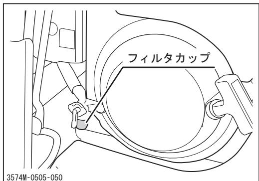
1. 付属の「エンジン取扱説明書」の指示に従って、燃料フィルタの点検・清掃を行います。
