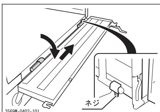
3. 側板を開き、前方にスライドして固定します。側板は水平と水平から60度の2段階に固定することができます。
