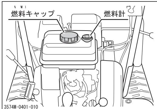
1. 燃料計を確認し、燃料が不足している場合は燃料を補給します。
