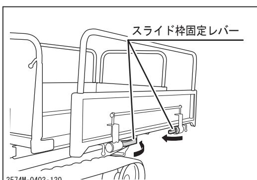
3. スライド枠固定レバーを倒して固定します。
