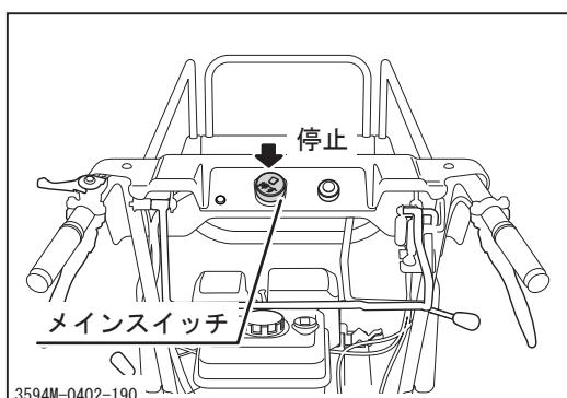
4. メインスイッチを押して「停止」にし、エンジンを停止させます。
