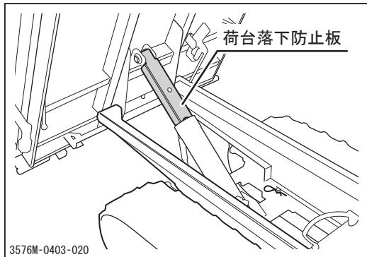
3. 荷台落下防止板を左図の向きに取り付け、荷台を確実に固定します。
