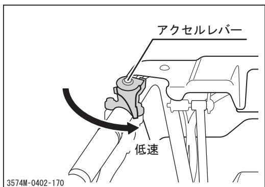
1. アクセルレバーを「低速」にし、エンジン回転数を下げ、車両を減速させます。
